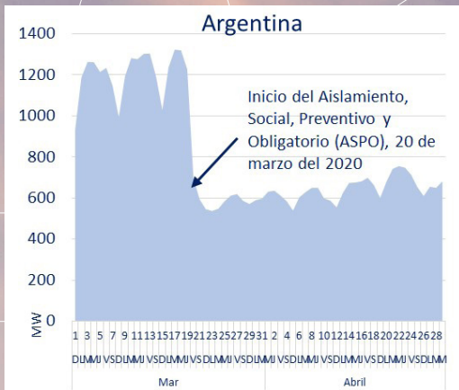
Figura 3. Argentina - Demanda del Sector Industrial. Elaboración propia a partir de datos de CAMMESA (CAMMESA, 2020).
